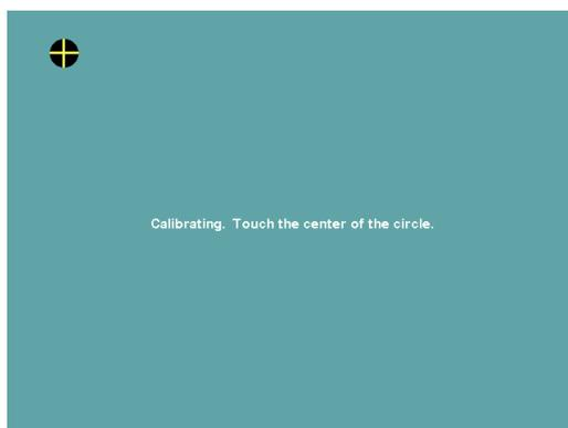
O alvo da tela sensível ao toque mostra ao operador onde tocar na tela para executar a calibração.
